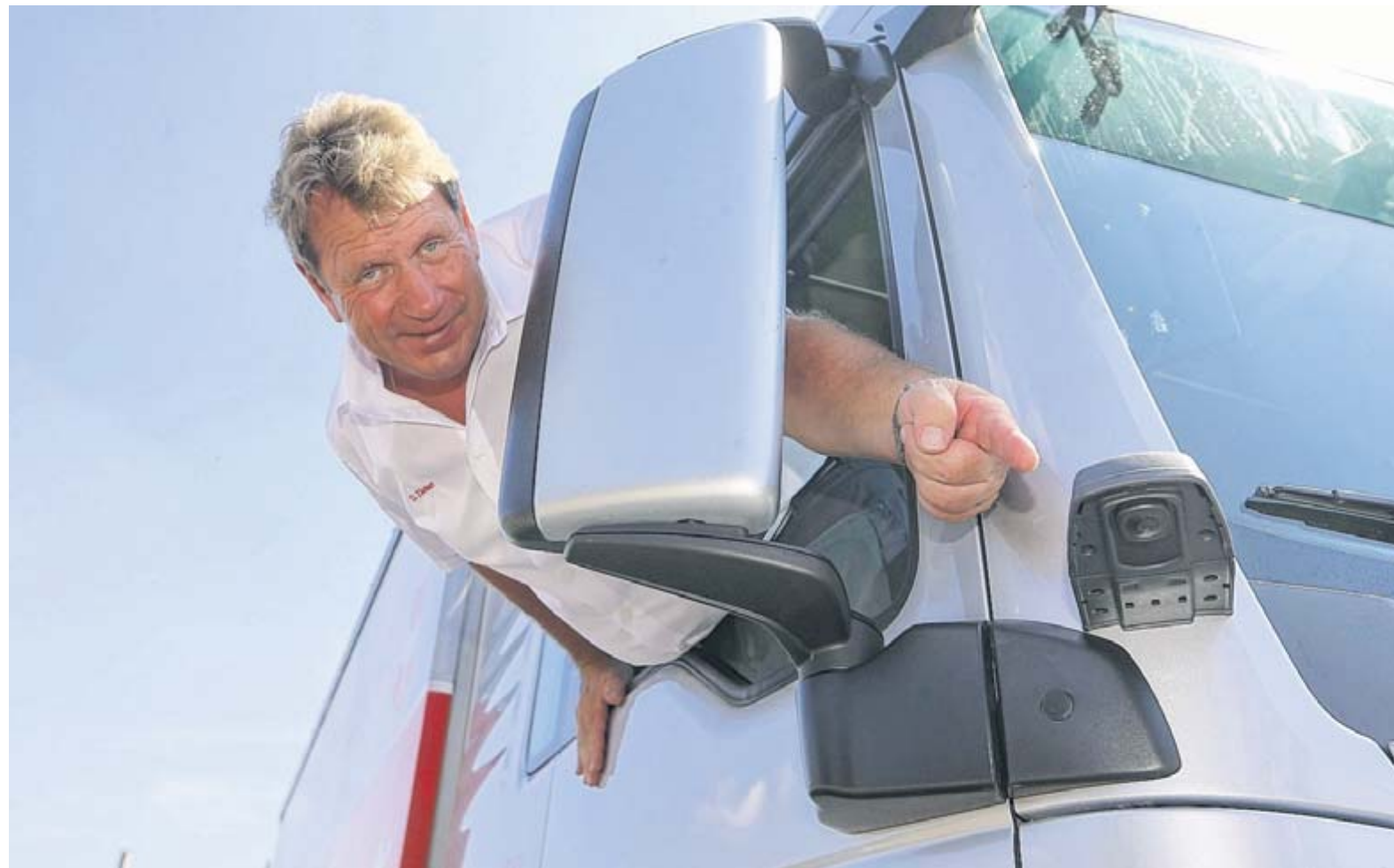
Die Kamera und ein Monitor machen sichtbar, was Dietmar Zänker als Lkw-Fahrer sonst unmöglich sehen kann: den sogenannten „toten Winkel“. Zänker ist Bereichsleiter einer Berufsschule. Beim Verkehrssicherheitstag am Sachsenring führte er gestern den Abbiegeassistenten vor. FOTO: ANDREAS KRETSCHER
